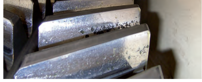
Rad der Zwischenstufe eines großen Pressengetriebes, hochvergütete Verzahnung Fortgeschrittene Pittingbildung dank ADDINOL Eco Gear gestoppt und stabilisiert.
