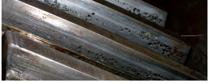
Abtriebsrad eines Walzwerksgetriebes, vergütete Verzahnung Ausbrüche an nahezu allen Zahnflanken. Diese wurden durch ADDINOL Eco Gear wieder eingeglättet.
