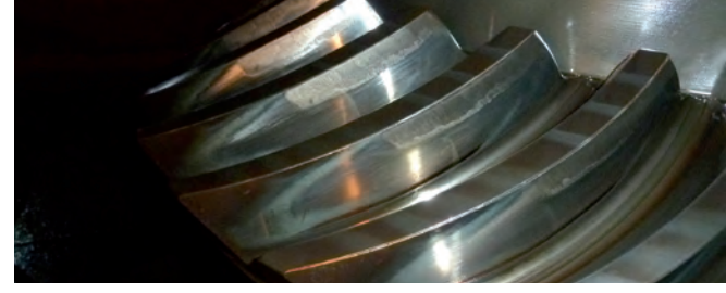
Kegelritzel eines Schüsselmühlengetriebes, gehärtet-geschliffene Verzahnung Durch fehlerhafte Einstellung lag Belastung auf nur einem Viertel der Verzahnung. Nach Justierung des Kegeltriebes deutliche Verbesserung des Tragbildes (ca. 75%). Anschließend Stabilisierung durch ADDINOL Eco Gear.
