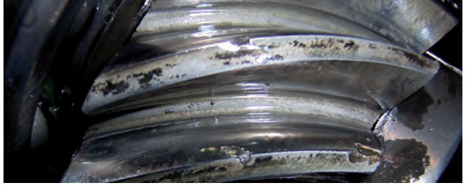
Kegelritzel eines Hubwerksgetriebes aus den 1950er Jahren Trotz großer Ausbrüche Weiterbetrieb über mehrere Monate, in denen ein neues Ritzel hergestellt wurde.
